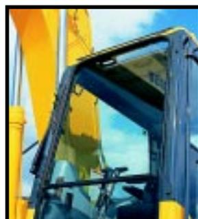
Limpador do Pára-brisa Montado na Coluna da Cabina
