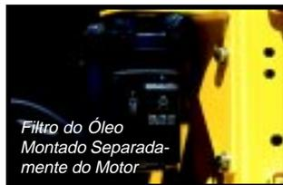
Filtro do Óleo Montado Separadamente do Motor
